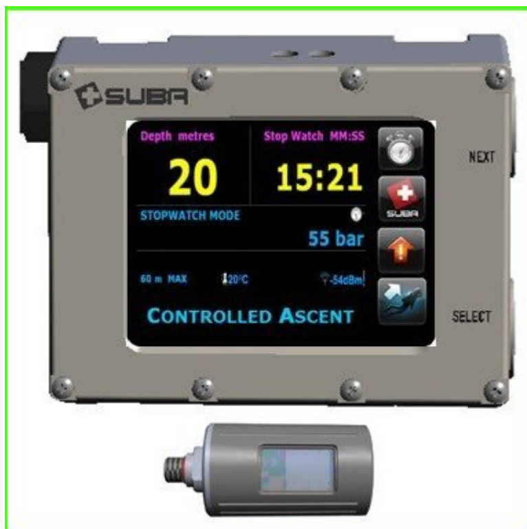
Figures 5 et 6 - Gilet SUBA équipé du Cruise Control, de son ordinateur et d'une sonde avec affichage de la Haute Pression
