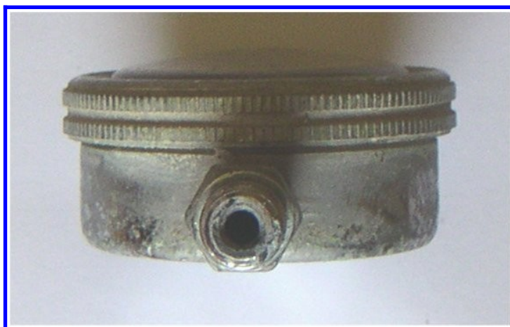
Entrée du manomètre HP encrassée
