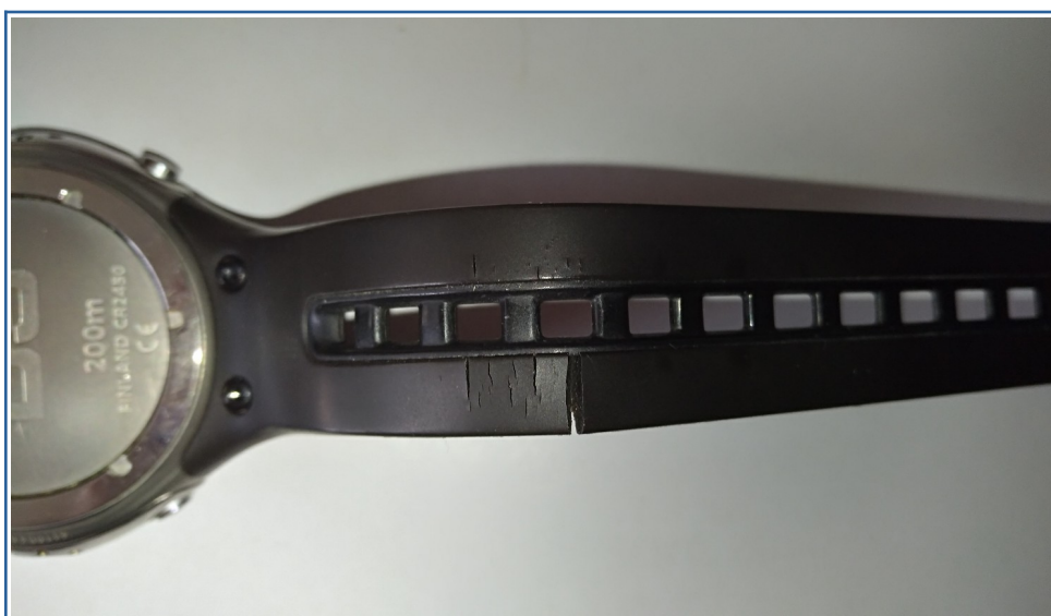
Amorce de rupture Bracelet Suunto D9
