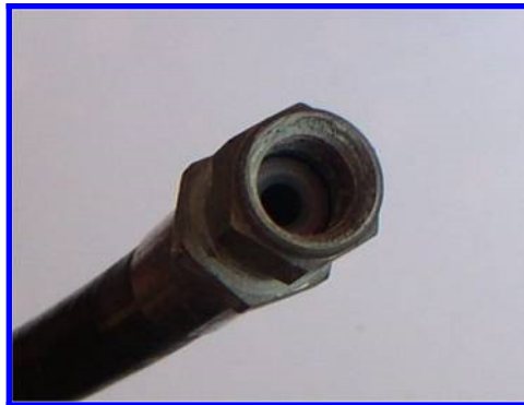
Connexion du flexible encrassé
