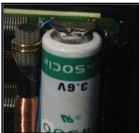
Soudure du moins
